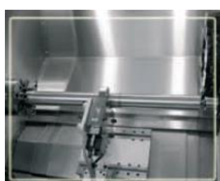
Hydraulická podpěra pro dlouhé tyče a hřídele
